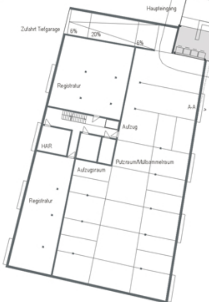
Grundriss Kellergeschoss M 1:200
